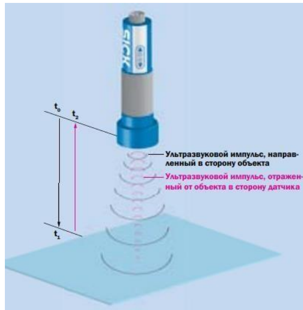
Рисунок 1.6 – Принцип работы ультразвукового датчика
